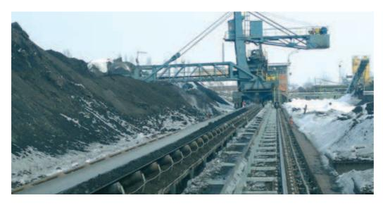
Hohe Schmutzbelastung und rauer Betrieb in der Kohleförderung. igus® Rollen e-ketten® geführt in robusten Stahlrinnen
