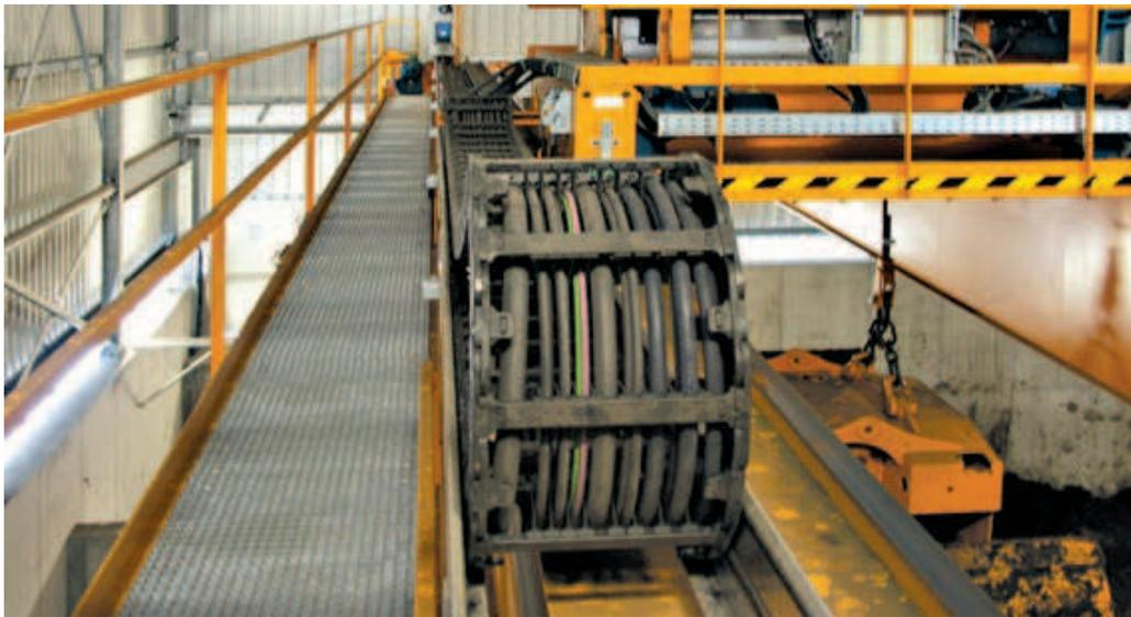
Stabile Führung ohne Schwingungen: Durch die kompakte Bauweise der Super-Alu-Rinne ist der Platzbedarf entlang dem Verfahrweg gering. Verfahrweg 32 m. Kranfahr-geschwindigkeit 80 m/min
